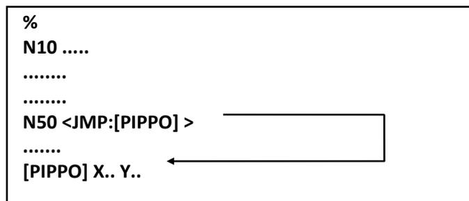
Nella **N50**, per effetto dell'istruzione **JMP**, l'esecuzione del programma viene trasferita al blocco identificato con l'etichetta **PIPP0**.
