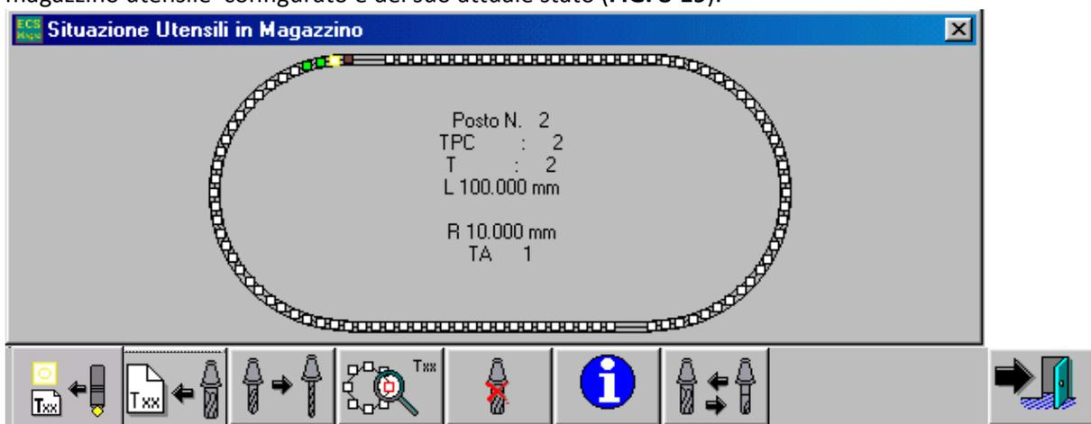
Nella rappresentazione grafica di **FIG. 8-19** ciascuna maglia della catena corrisponde ad un posto del magazzino. In particolare il colore della casella indica la presenza o meno di un utensile montato nonché le sue dimensioni il tutto attraverso una specifica codifica.
