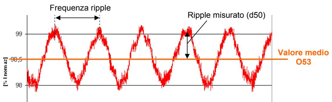
Per poter misurare correttamente il ripple sul modulo della corrente è fondamentale tarare opportunamente i filtri digitali implementati che sono del tipo passa-banda. I parametri coinvolti sono **P182** e **P183** che esprimono le costanti di tempo corrispondenti alla figura sottostante:
