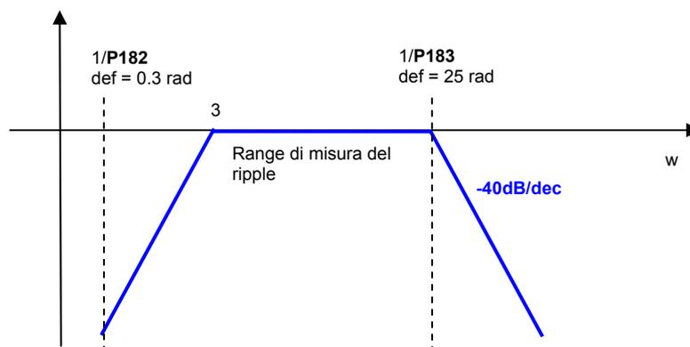
La frequenza del ripple da misurare dipende dalla velocità di rotazione del cesto della lavatrice, pertanto si dovrà far in modo di centrare il range utile di misura con la banda di frequenza significativa.
