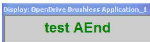
Figura 8- Fine dell'autotuning con drive in marcia
