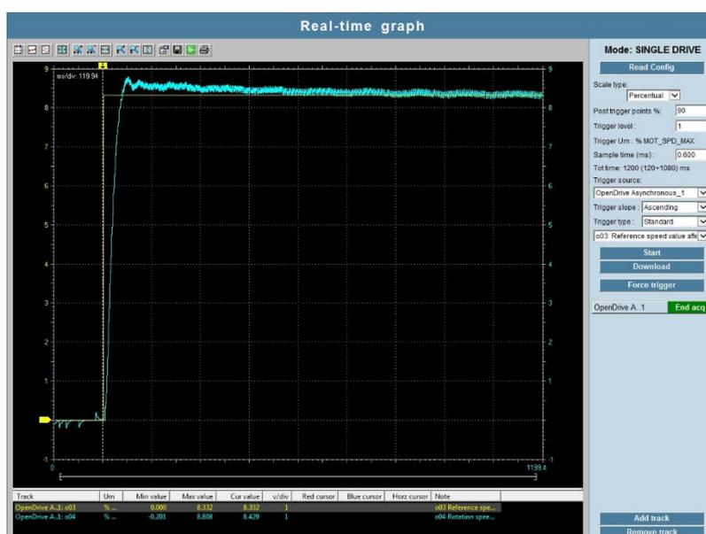
Figura 14-Risposta al gradino di velocità con costante di anticipo tarata
