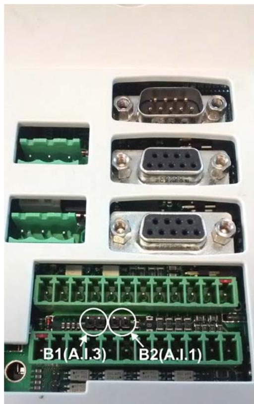
FIG. 18 (Configurazione Ingressi Analogici)
