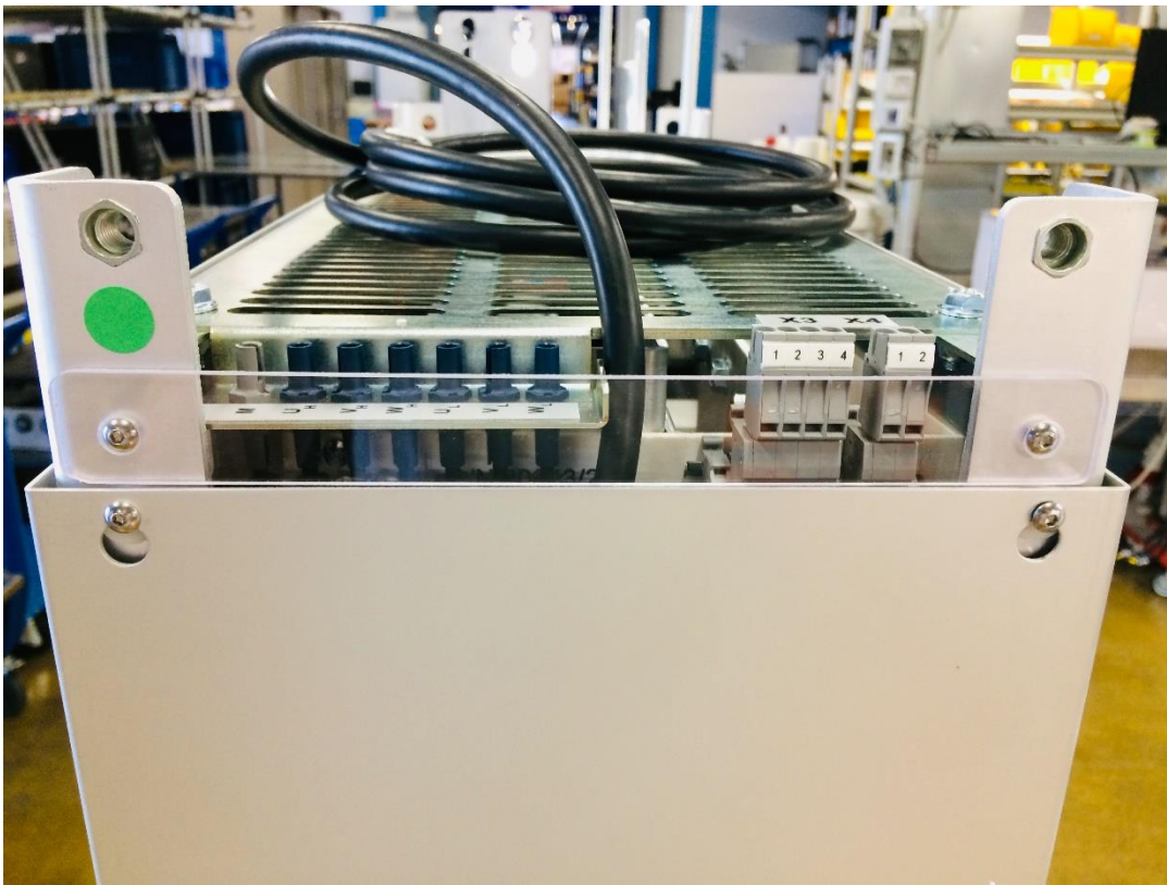
Fig. 10 (Cavo dei segnali lato Stack)
