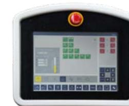
L'HMI **integra i comandi principali** per, robot e automazione per l'asservimento delle presse stampaggio di materie plastiche, facilitando le operazioni dell'operatore.
