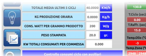
BDF Digital si interfaccia con gli analizzatori di rete/contatori di energia dedicati alla gestione energetica: sono in grado di fornire informazioni e tracciare l'andamento dei consumi. L'osservazione del tracciato della potenza istantanea e/o media, permettono di verificare le condizioni di carico e di definire il **consumo per grammo e per commessa**.
