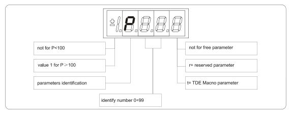
FIG. 2 (Parameters PAR)
