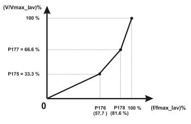
"TYPICAL CURVE WITH QUADRATIC TORQUE LOAD"
